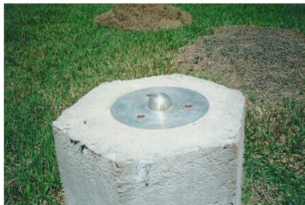
Figura 23 - Dispositivo de Centragem forçada padrão UFPR fechado.
