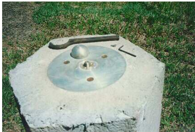
Figura 22 - Dispositivo de Centragem forçada padrão UFPR aberto.
