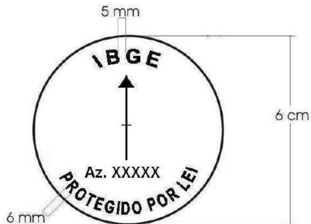
Figura 6 – Especificação da Chapa de Azimute.
