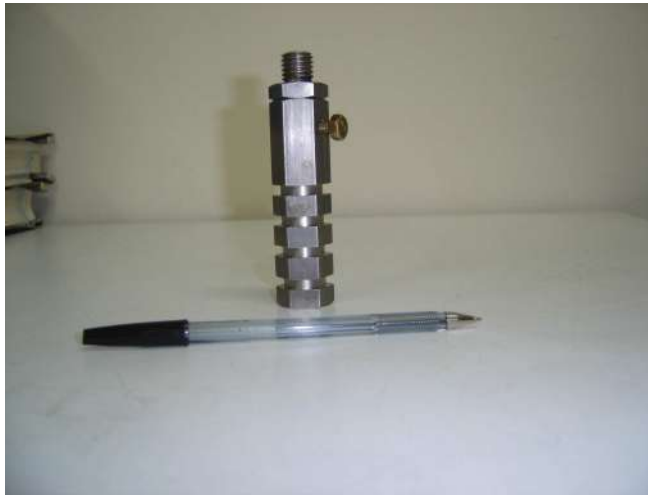
Figura 26 - Pino de centragem forçada padrão IBGE.
