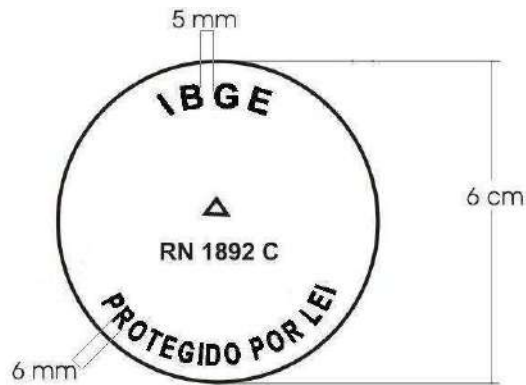
Figura 5- Exemplo de Chapa de Referência de Nível.
